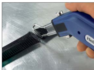
Uitrafelen bij het doorsnijden van een gevlochten kous kan met de HSG0 worden vermeden.
