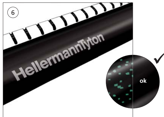
Controleer of de TCP-stippen verdwenen zijn en of er wat lijm uit de uiteinden vloeit om vast te stellen of de manchets volledig is gekrompen, met name aan de achter- en onderzijde.
