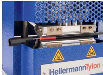
Un appui sur le pédalier initialise le process de rétreint. Les 2 tampons spéciaux chauffés et élastiques encapsulent le produit thermorétractable tout en transférant la chaleur de façon très efficace et avec un minimum de perte calorifique.
