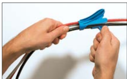
1- Insérez un ou plusieurs câbles dans la fente de l'outil.
