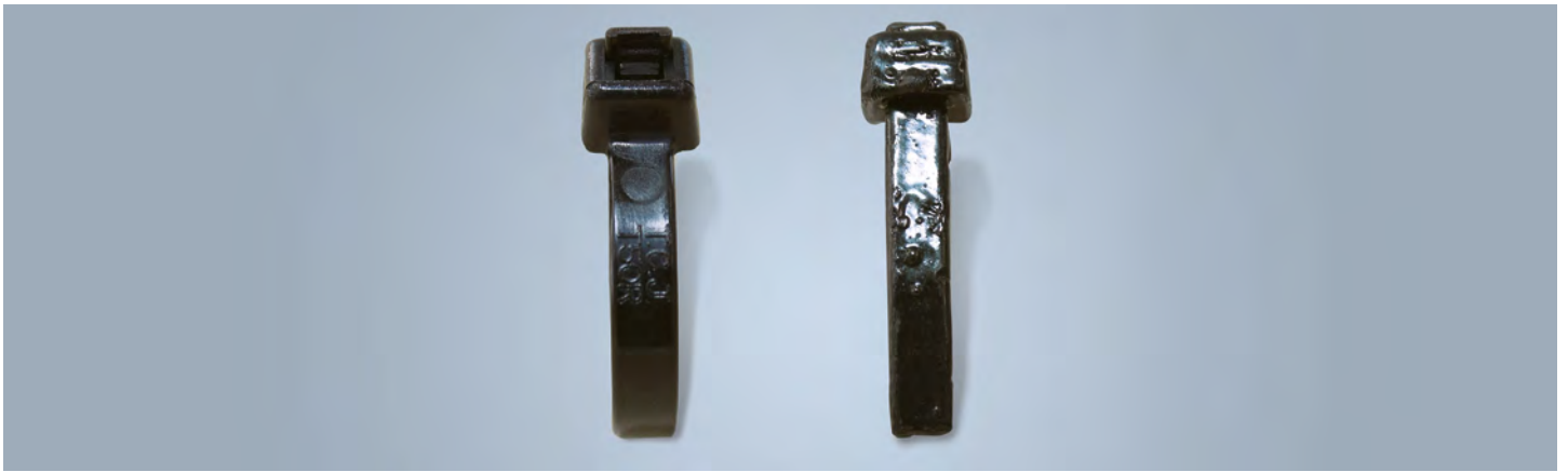
GalvaLok-bundelbanden en bundelbanden uit PA66 na 24 uur in een verzadigde zinkchloride-oplossing bij +90 °C.
