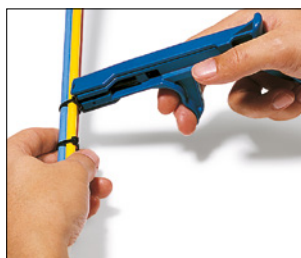
Serrage du collier grâce à l'outil.
