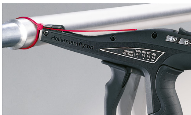
1: Serrage du collier, tel n'importe quel outil de pose manuel.
