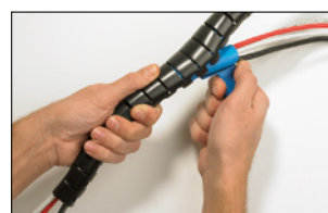
Puis glisser simplement l'outil au travers de la gaine.
