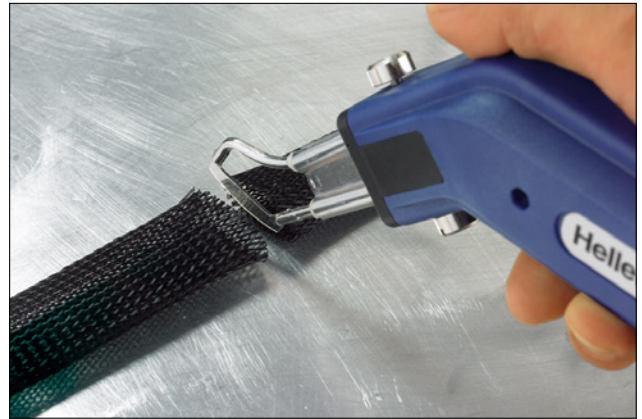
L'outil de coupe HSG0 évite l'effilochage des gaines tressées.
