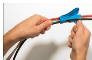
Insérer un ou plusieurs câbles dans la fente de l'outil.
