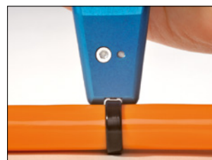
... exercer une légère pression pour que la bande pénètre correctement dans la gorge de l'outil...
