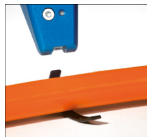
... Une fois la bande coupée, dégager l'outil et récupérer le résidu de collier.
