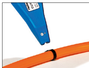
Amener l'outil, perpendiculairement, au contact du collier...
