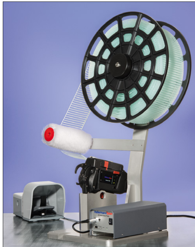
Autotool 2000 et l'ensemble de montage sur table.
