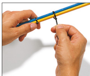
Mise en place d'un collier de serrage plastique.
