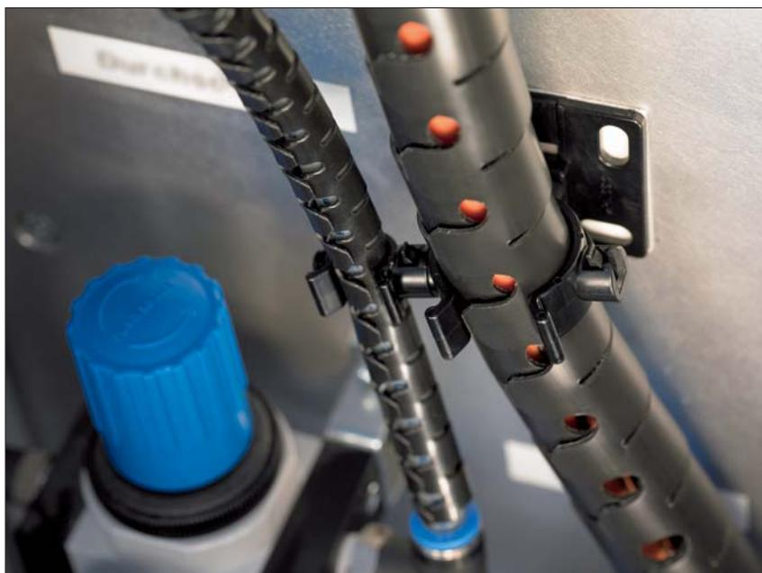
Grâce à la gamme d'accessoires Helawrap, les câbles peuvent être maintenus, protégés et fixés dans des armoires de câblage ou des machines industrielles.
