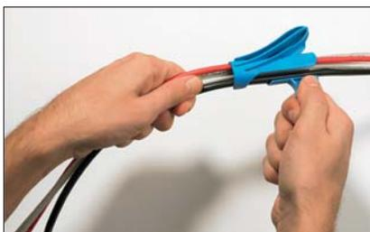
Glisser un ou plusieurs fils ou câbles dans le trou d'insertion de l'outil de pose.
