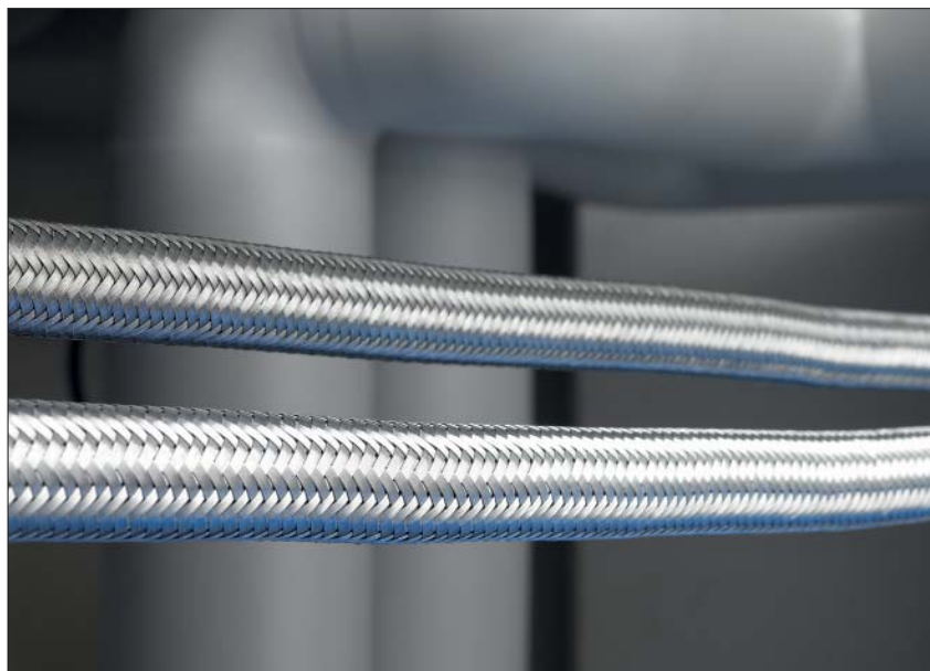
La gaine en acier galvanisé HelaGuard PCSB avec revêtement PVC et un surtressage en acier galvanisé offre une très bonne tenue à l'abrasion et une protection EMI.
