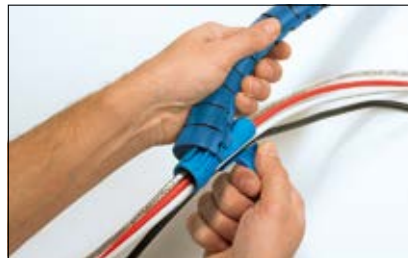
Zet het tooltje aan een van de uiteinden van de slang.
