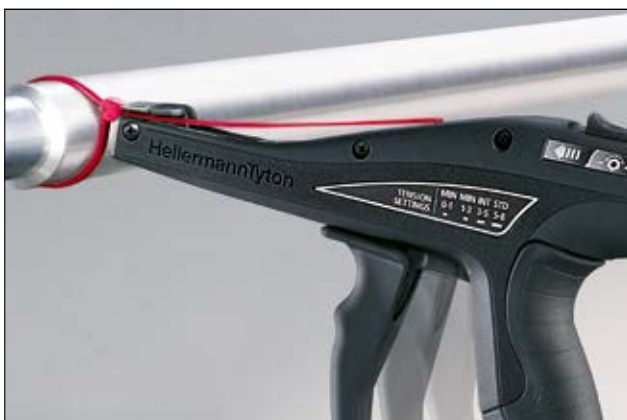
1: Tension: band wordt als gebruikelijk aangespannen.
