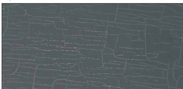
La structure est entièrement endommagée à cause de l'exposition aux UV.
