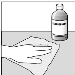
**1.** Les surfaces doivent être sèches, exemptes de poussières, d'huile, d'oxydes, de lubrifiant et autre impureté. La surface de collage doit être nettoyée au préalable avec un chiffon propre et un mélange d'isopropanol et d'eau en quantité égale. En cas d'utilisation d'autres nettoyants appropriés, il faut veiller à ce qu'ils n'attaquent pas la surface et qu'ils ne laissent aucun résidu.
