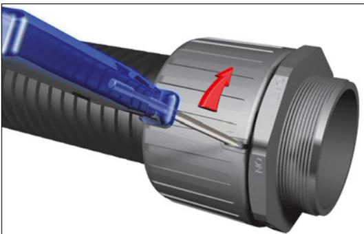
3. Poussez le manche du tournevis vers la position "off". L'écrou va légèrement tourner et le raccord est ainsi déverrouillé.
