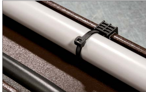
T50ROSEC23 – Le tube ou faisceau de câbles à maintenir est positionné parallèlement au bord.
